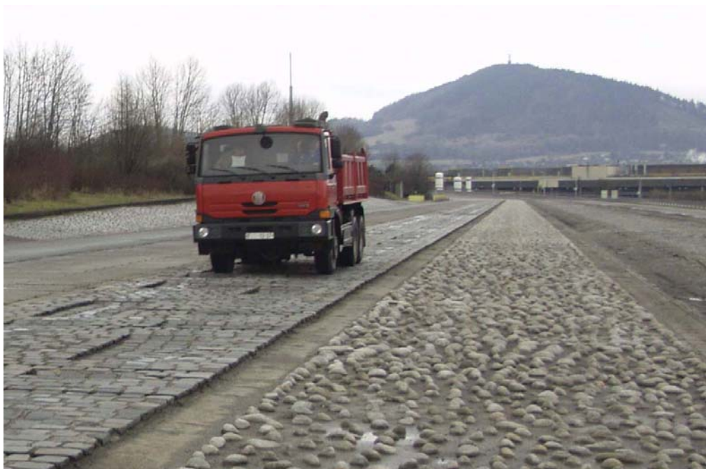
Obr. 2.5-5: Nákladní automobil TATRA T815 – 230 S25 6×6 na zkušebním polygonu firmy TATRA (jízda po BELGICKÉ, vpravo zkušební vozovka BULIŽNÍK)
