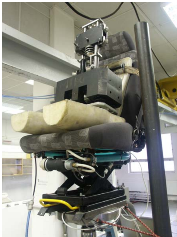
Obr. 2.5-3: Funkční vzor sedadla KAMAZ s aktivní vibroizolací zatěžovaný mechanickým modelem části lidského těla
