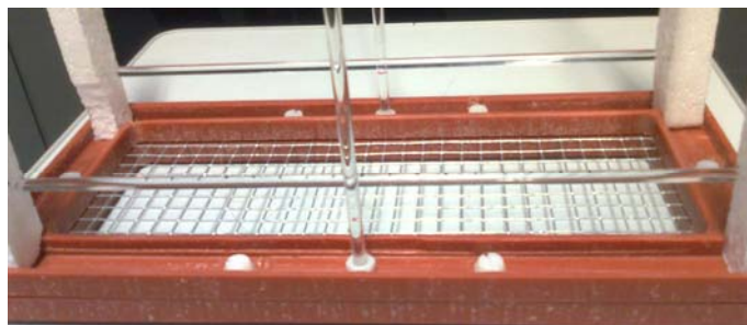
Obr. 13: Fotografie kondenzátoru se síťovou elektrodou a novými horizontálními skleněnými tyčkami
