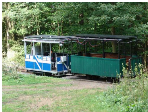
Fig. 11. Souprava hnacího (modrý) a vlečeného vozu osazených fotovoltaickými panely
