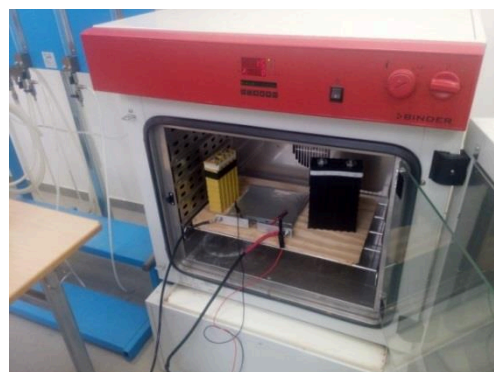
Fig. 3. Pec pro měření článků při zvýšené teplotě s proměřovanými články (zleva 100 Ah, 25 Ah, 40 Ah)
