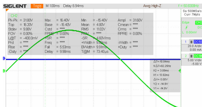
Obr. 5. Napětí při deaktivovaném tyri. modulu = naprázdno na tyristoru.
