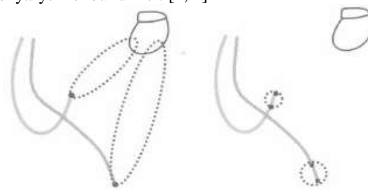
Fig. 1. Rozdíl v umístění katody a anody v bipolární a unipolární konfiguraci kardiostimulátoru.
