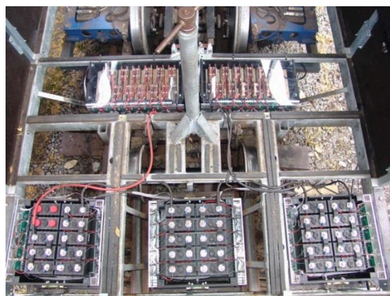
Fig. 9. Dvě Li baterie na experimentálním vozidle Univerzity Pardubice (menší baterie – 26 článků NMC25 Ah, větší baterie – 28 využitých článků LFP 100 Ah)
