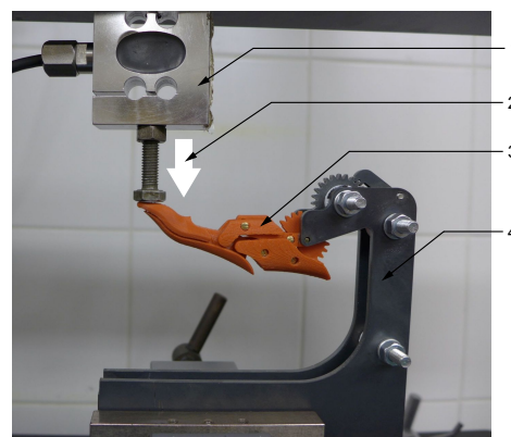
Obr. 5. Mechanické testování ukazováku HACKberry na trhačce (1 – snímač síly, 2 – směr pohybu, 3 – testovaný prst, 4 – držák prstu) [9]
