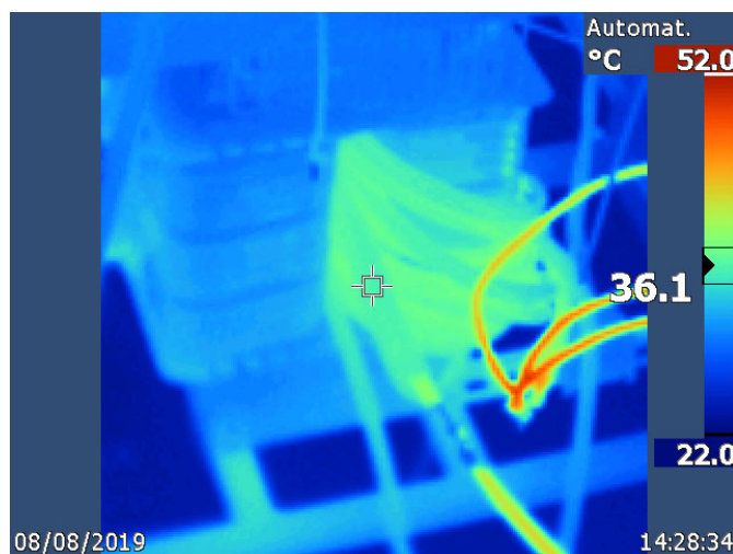
Obr. 9. Provizorní sekundární vinutí AWG2 = 33,6 mm 2 je v s nezatíženým oteplením, spojka 2 × 4 mm 2 je zatížená více.
