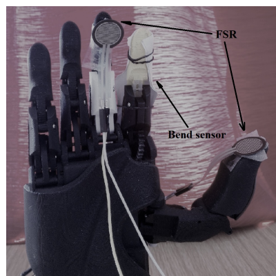
Obr. 4. Ruka HACKberry vybavená snímači na prstech [11]
